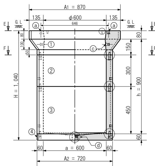
A:長辺外側幅, B:短辺外側幅, H:外側高さ a:長辺内側幅, b:短辺内側幅, h:内側高さ
