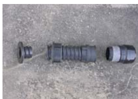
1 独立山管用の差込継手は 形状が異なります
