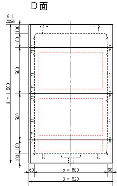
A：長辺外側幅，B：短辺外側幅，H：外側高さ      a：長辺内側幅，b：短辺内側幅，h：内側高さ
