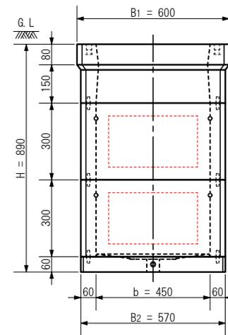
A：長辺外側幅，B：短辺外側幅，H：外側高さ a：長辺内側幅，b：短辺内側幅，h：内側高さ
