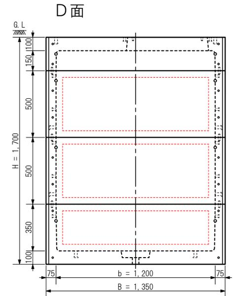
A : 長辺外側幅, B : 短辺外側幅, H : 外側高さ a : 長辺内側幅, b : 短辺内側幅, h : 内側高さ
